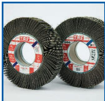
Vengono impiegate su smerigliatrici portatili o fisse per la lavorazione di acciaio inossidabile, acciaio dolce, leghe speciali, metalli non ferrosi. Il montaggio sull'albero della smerigliatrice si effettua mediante una coppia di flange di riduzione.
