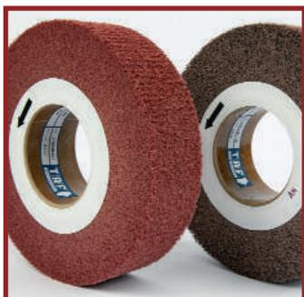
Le ruote RL118 si utilizzano per operazioni di finitura e satinatura di svariate superfici metalliche. Si montano sull'albero della macchina pulitrice tramite una coppia di flange di riduzione.
